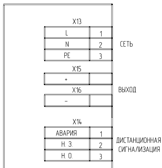
Рис.6.3. Схема подключения выпрямителей ВБВ 60/6-МК, ВБВ 48/7-МК, ВБВ 24/12-МК для самостоятельной работы (в кожухе)
