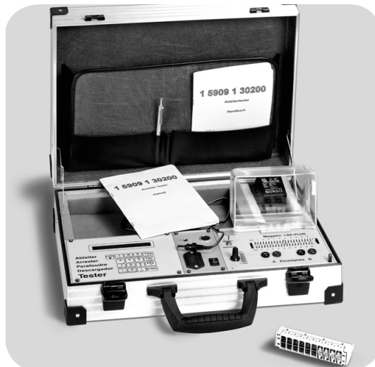
Испытательный прибор ComProtect поставляется в переносном кейсе. Адаптеры и программное обеспечение поставляется отдельно.
