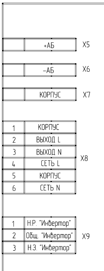
Рис. 12.3. Схема подключения ИЦ-600БП-19
